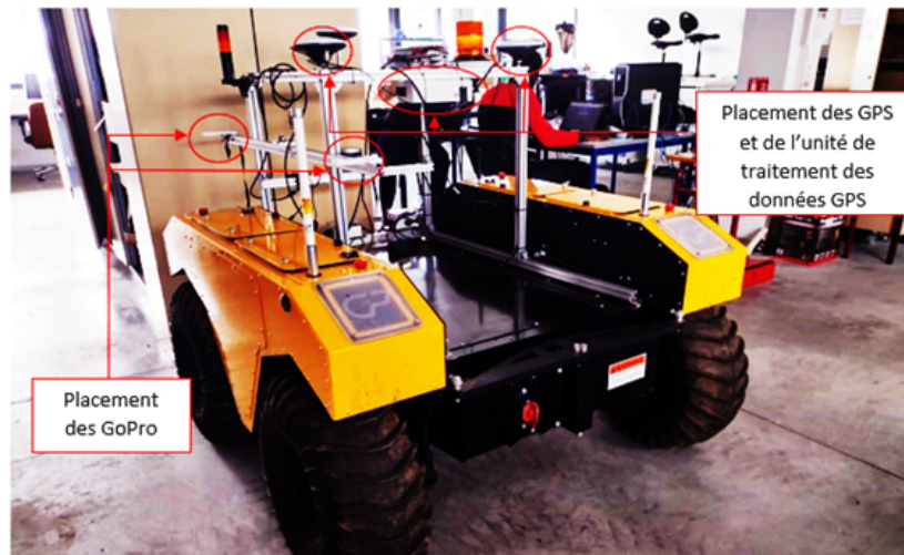
FIGURE 4 – Installation du matériel de photogrammétrie
