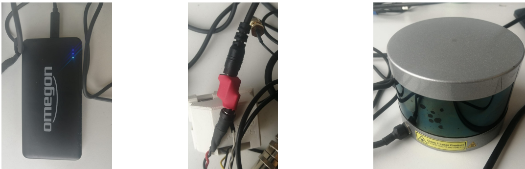
FIGURE 10 – La batterie externe, le nouveau connecteur et le Velodyne
