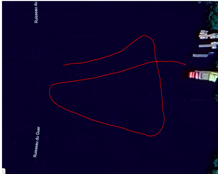
FIGURE 7 – Suivi du petit triangle de tests avec lookahead
