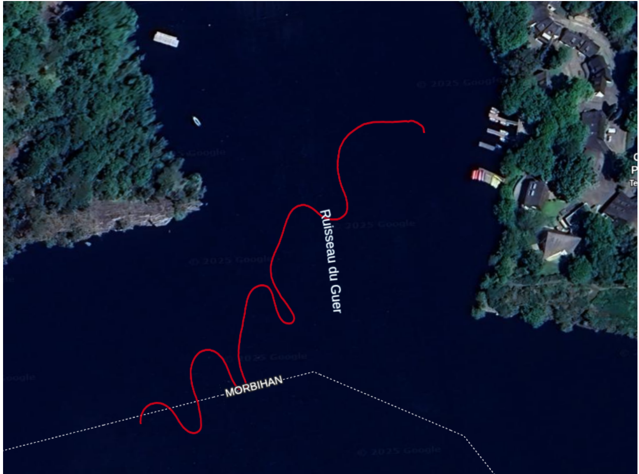
Figure 4.2 Log GPS de la trajectoire réalisée par le DD-Boat avec les mauvais paramètres.
