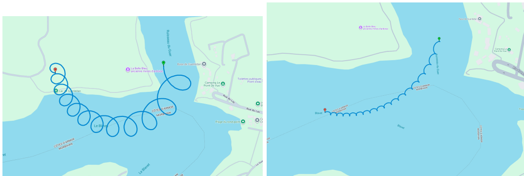
FIGURE 6 – Forme de la trajectoire théorique d'un bateau en chasse de la "proie" pour différents paramètres
