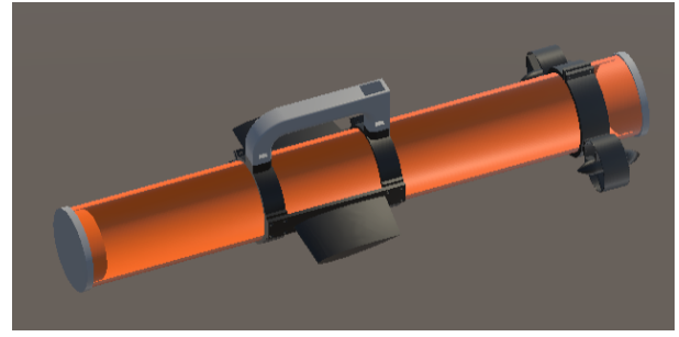
FIGURE 2. CAO du robot. En orange le tube en acrylique, en gris les pièces par SLA et en noir les pièces par FDM, l'amortisseur n'est pas visible
