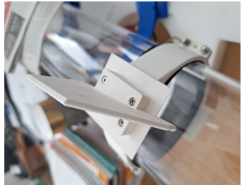
FIGURE 2.2 – Ailes inclinées — modélisation (gauche) et pièce réelle (droite).
