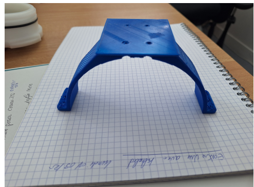
FIGURE 2.3 – Colliers de fixation — modélisation (gauche) et pièce réelle (droite).
