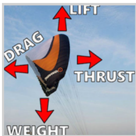
Figure 2 : Schéma des forces principales s'appliquant au paramoteur
