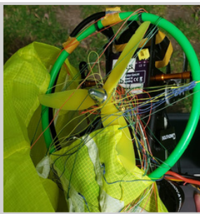
Figure 33 : Photo de la voile prise dans l'hélice du paramoteur
