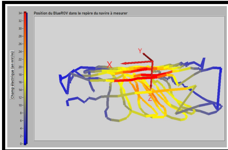
FIGURE 22 – Affichage de la norme du champ électrique mesuré au cours d'un passage sous un dipôle (deux sources de courant)
