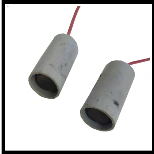
FIGURE 11 – Électrodes de MAPPEM Geophysics installée sur le BlueROV
