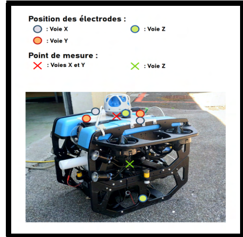
FIGURE 12 – Positionnement des électrodes sur le BlueROV
