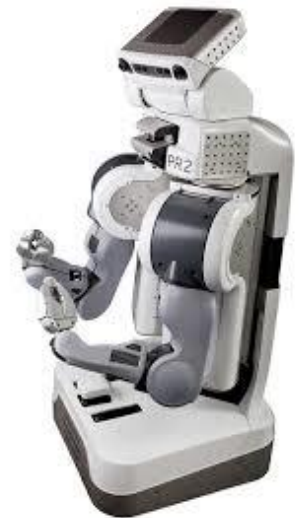
Figure 5 : Le robot PR2, le premier fonctionnant sous ROS
