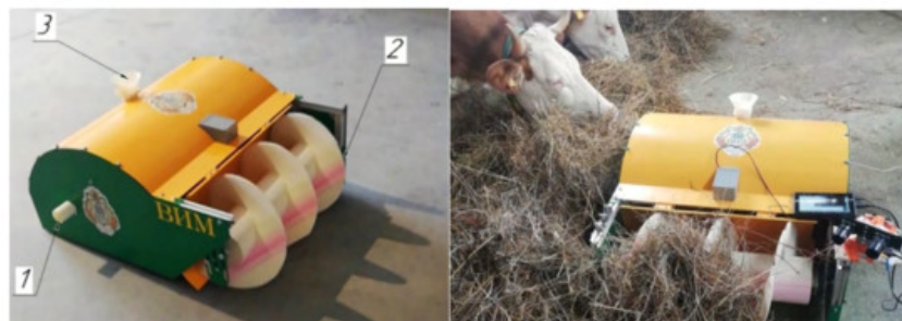
FIGURE 3 – Analogie physique d'un robot pousseur ; 1, sortie du distributeur d'additifs alimentaires ; 2, vis de poussée ; 3, remplisseur avec une fermeture [12]
