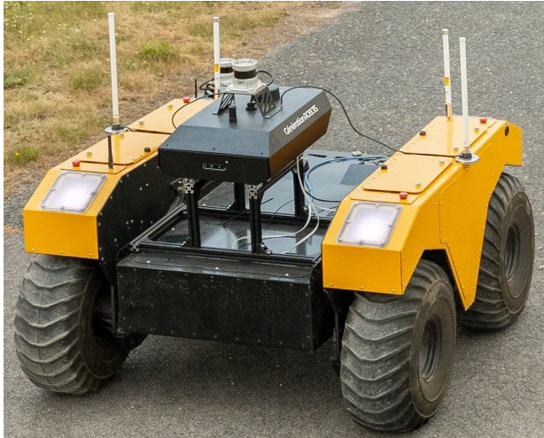
(a) Clearpath Warthog utilisé pour les expérimentations réelles
