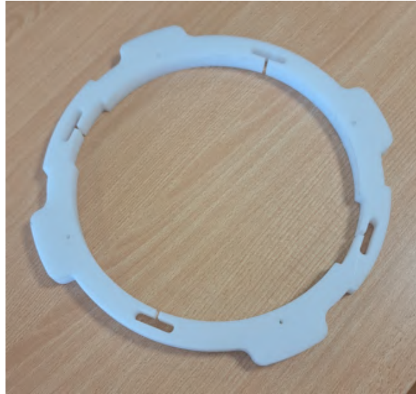
FIGURE 35 – Anneau partiellement usiné
