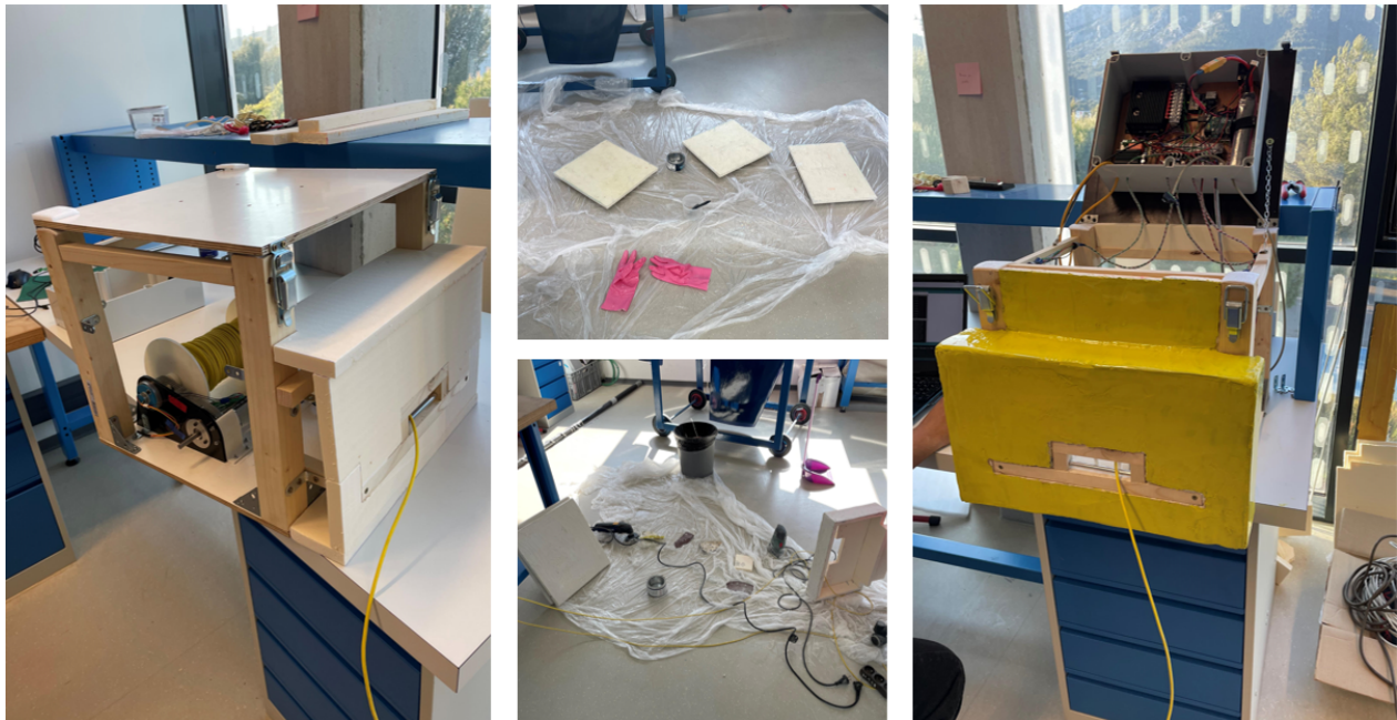
Figure 3.15 – Photographies de la structure en bois supportant la solution, aux différentes étapes de la fabrication de l'armature étanche en mousse : avant (gauche), pendant (centre) et après (droite).
