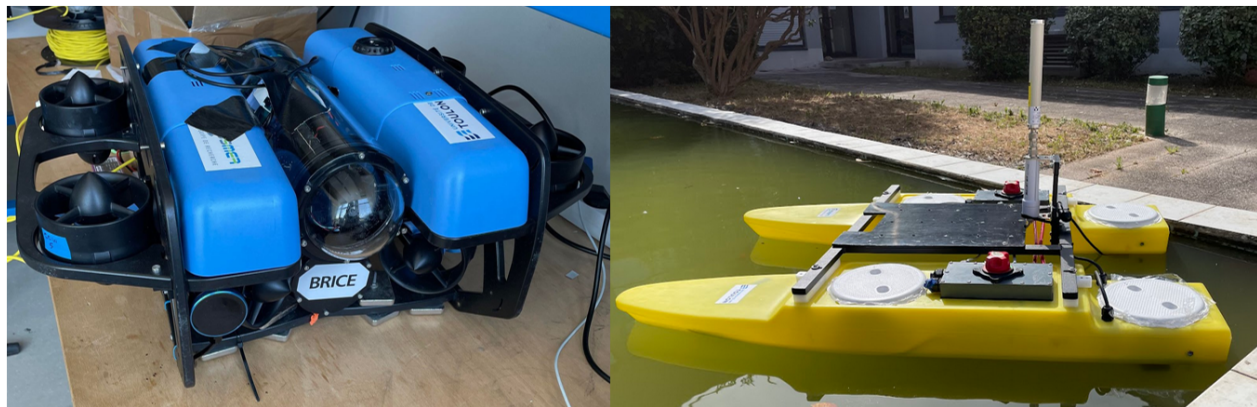
Figure 4.1 – Photos des robots utilisés dans cette thèse : ROV (gauche) et USV sans l'enrouleur (droite)
