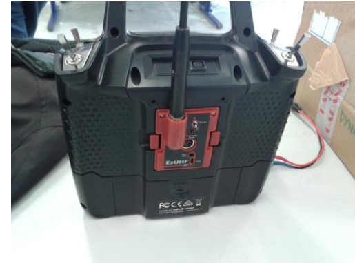
Télécommande Turnigy 9XR Pro avec un émetteur externe Immersion RC EzUHF 433 MHz dans sa baie JR
