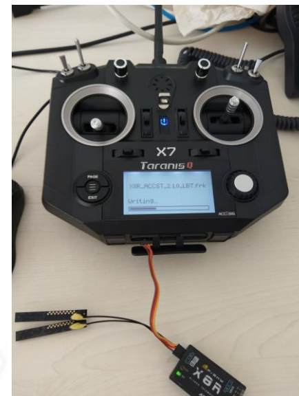
Mise à jour d'un récepteur FrSky X8R avec une télécommande FrSky Taranis QX7 ACCESS contenant une carte SD avec le bon firmware
