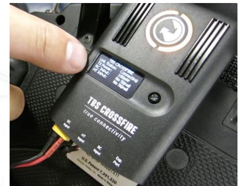
Emetteur externe TBS Crossfire 868 MHz dans la baie JR d'une télécommande. Il est muni d'un écran et d'un bouton-joystick servant à sa configuration ainsi qu'à celle des récepteurs connectés
